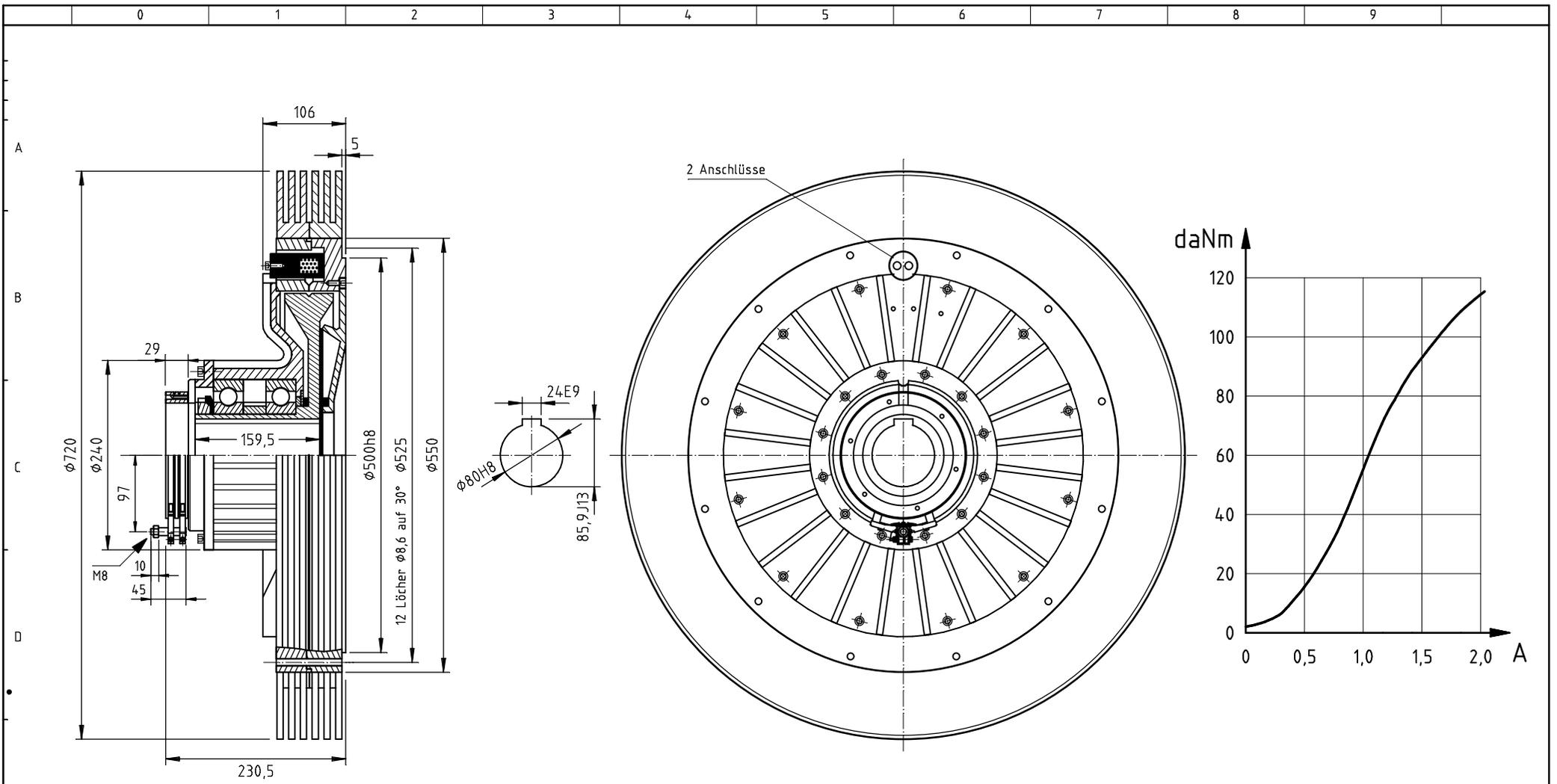
Um keinen magnetischen Streufluß und eine gute Wärmeabführung zu bekommen, sollte beim Einbau oder Anbau von Zusatzbauteilen NE- Metall verwendet werden (außer Antriebswelle).
