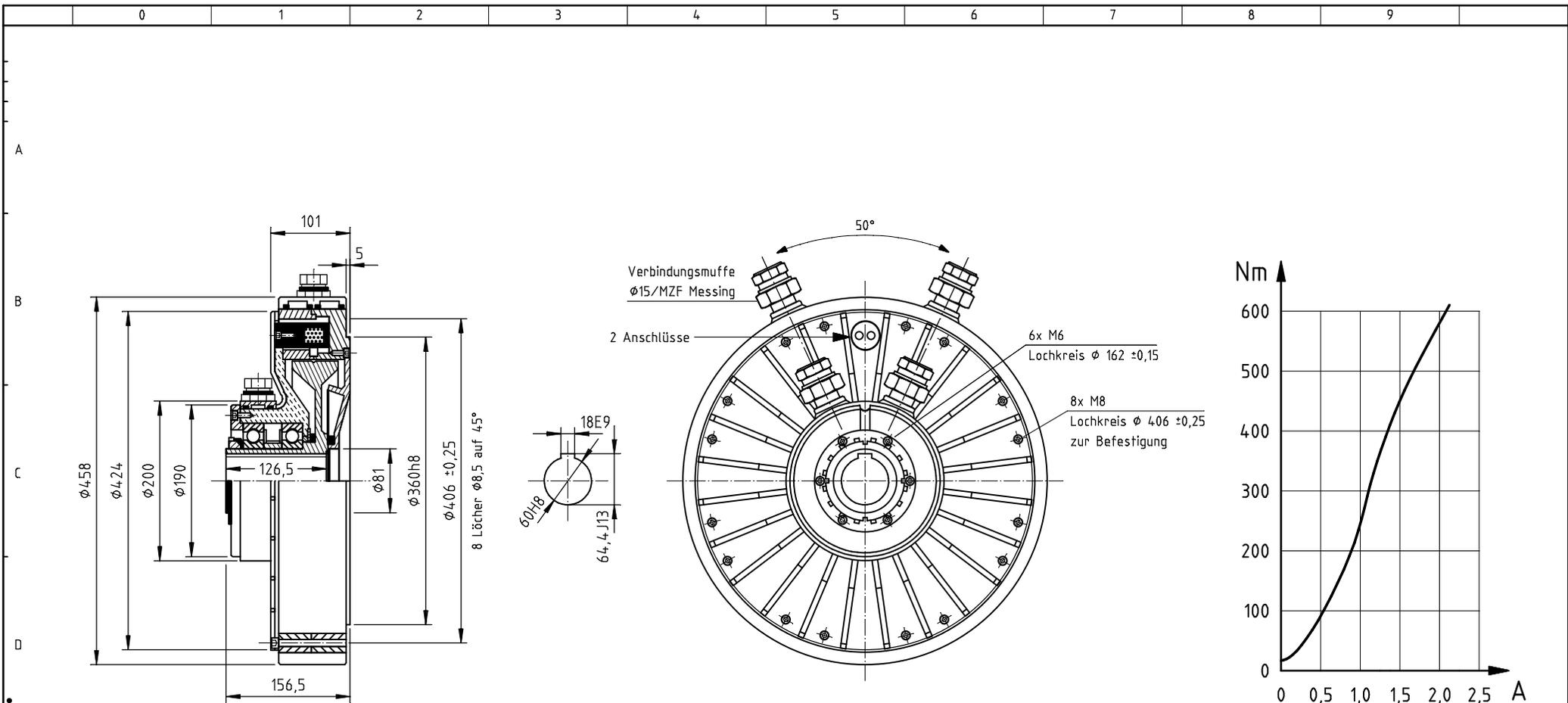
Um keinen magnetischen Streufluß und eine gute Wärmeabführung zu bekommen, sollte beim Einbau oder Anbau von Zusatzbauteilen NE- Metall verwendet werden (außer Antriebswelle).
