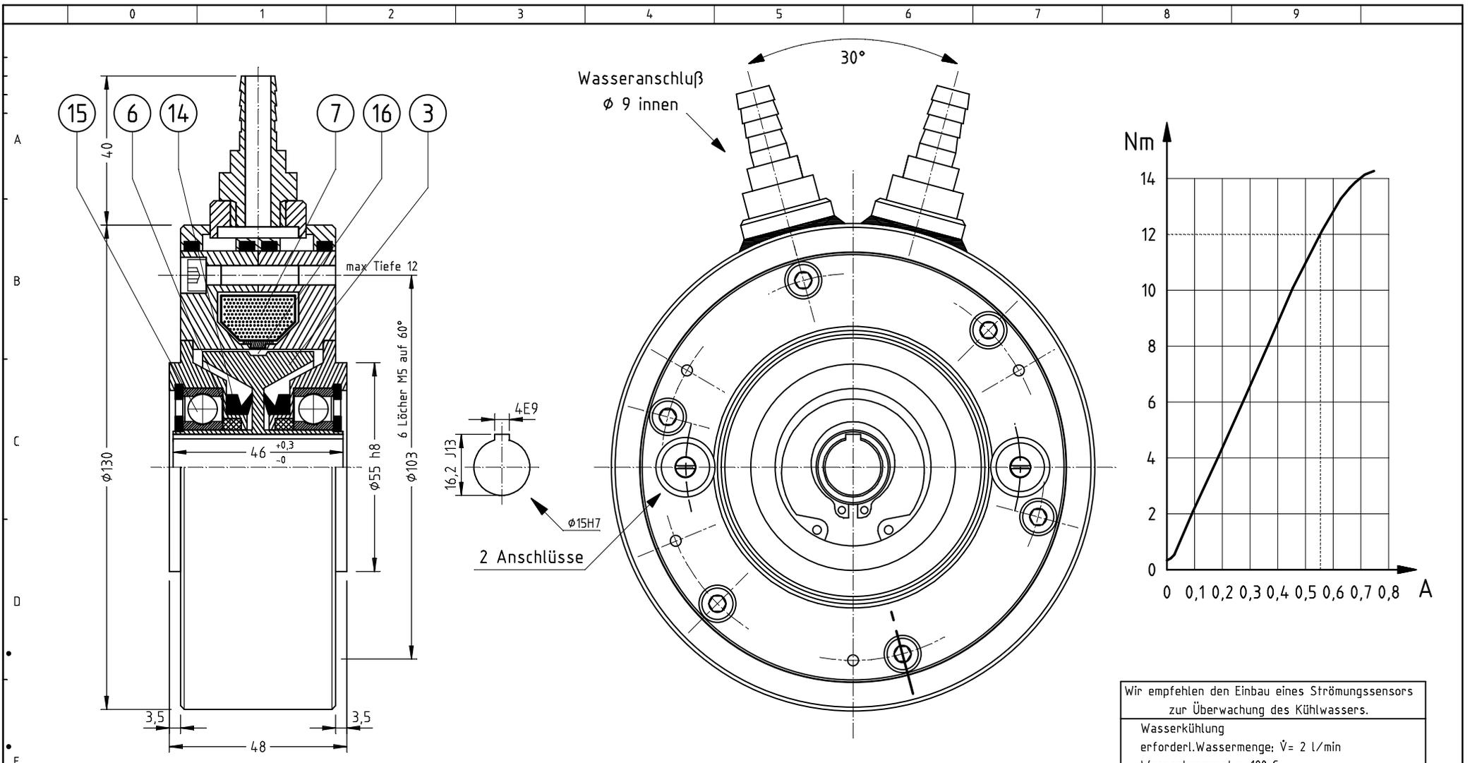
Um keinen magnetischen Streufluß und eine gute Wärmeabführung zu bekommen, sollte beim Einbau oder Anbau von Zusatzbauteilen NE- Metall verwendet werden (außer Antriebswelle).
