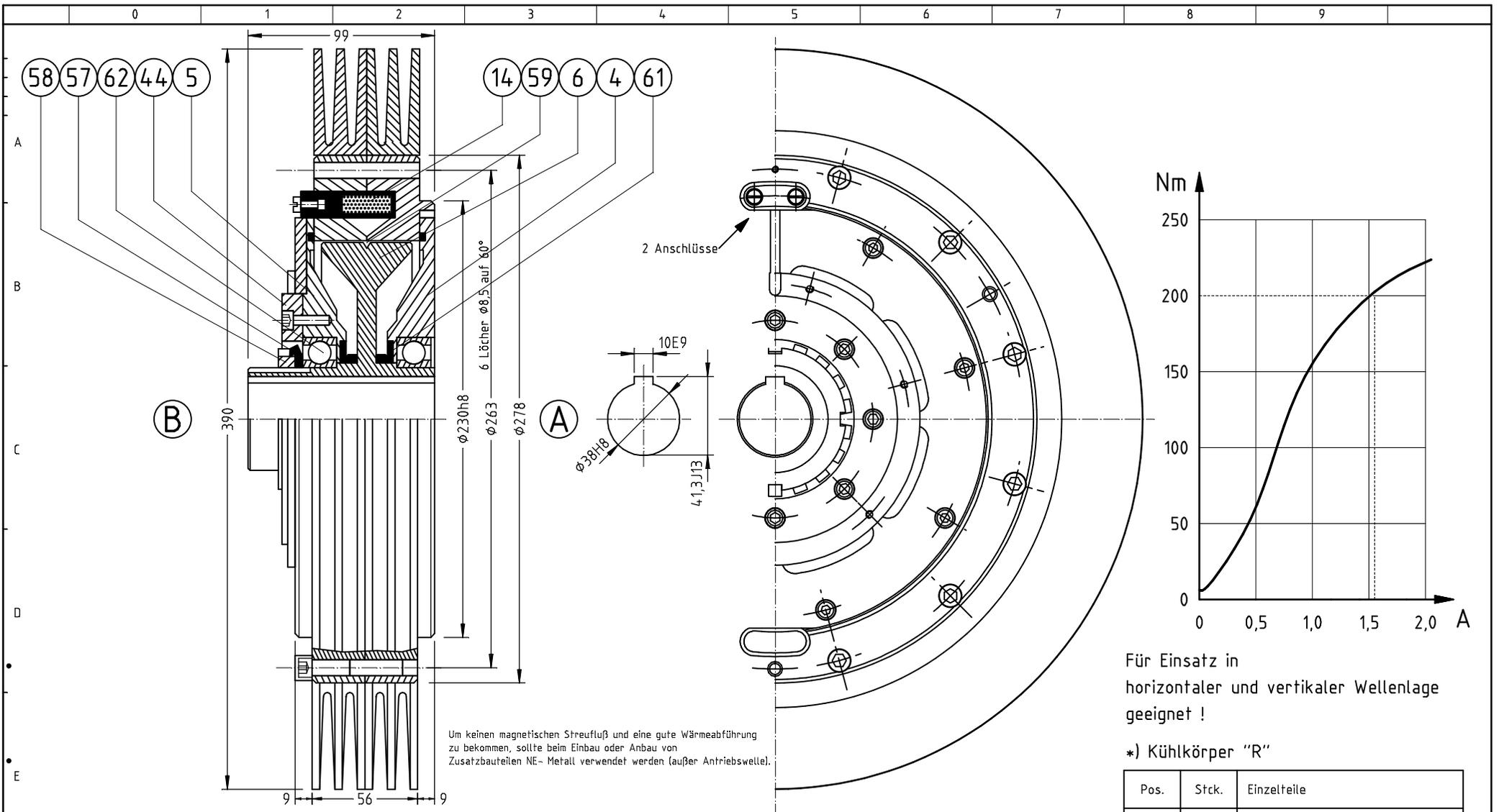
Um keinen magnetischen Streufluß und eine gute Wärmeabführung zu bekommen, sollte beim Einbau oder Anbau von Zusatzbauteilen NE- Metall verwendet werden (außer Antriebswelle).
