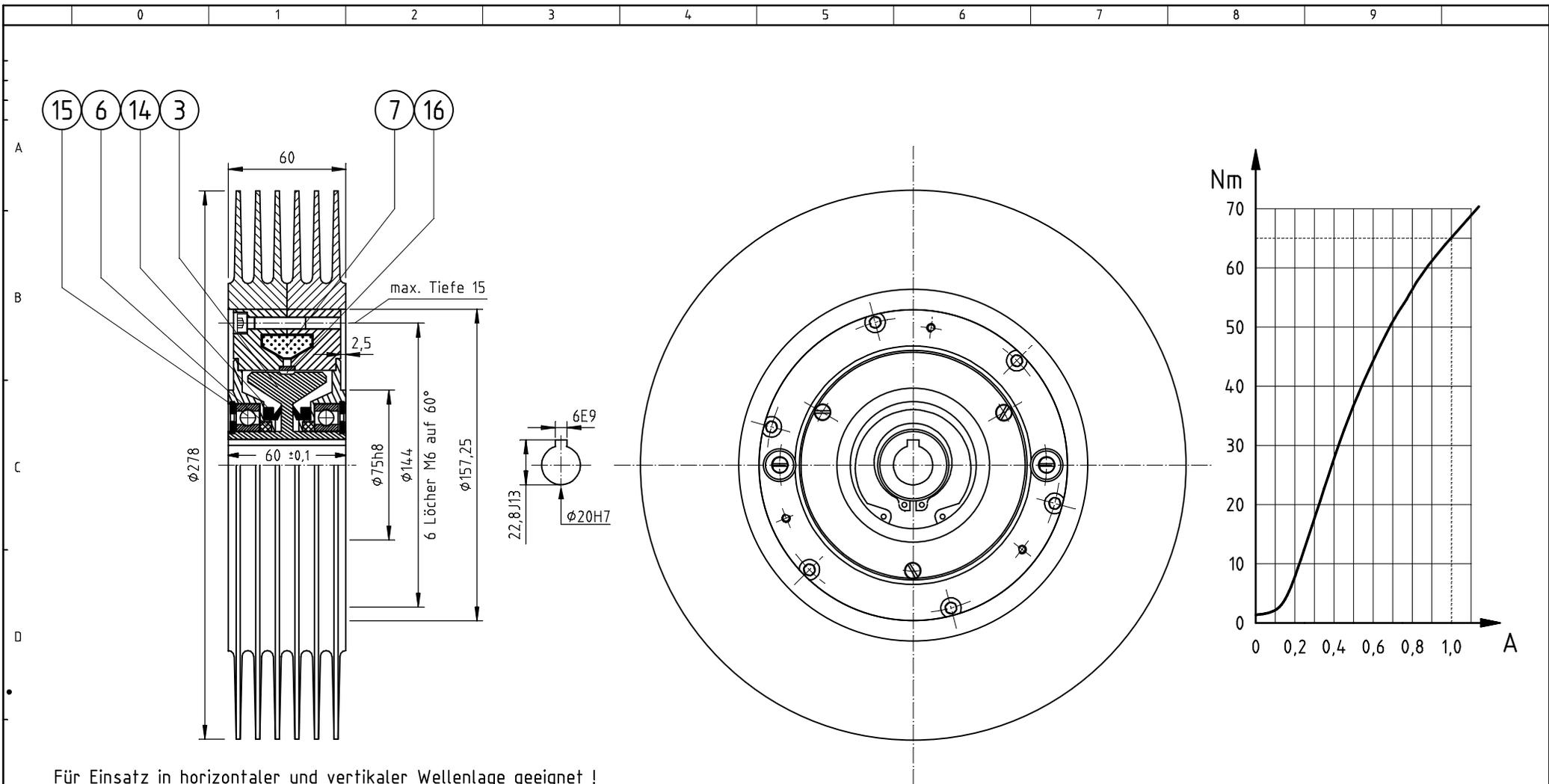
Für Einsatz in horizontaler und vertikaler Wellenlage geeignet !
