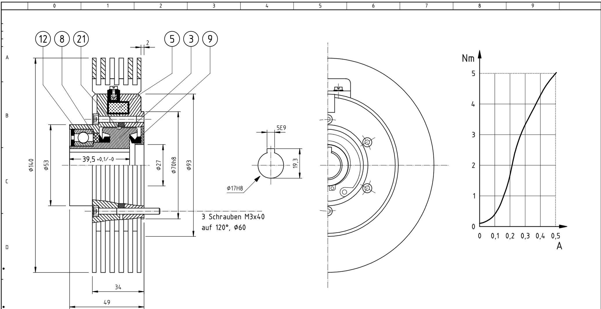
E Um keinen magnetischen Streufluß und eine gute Wärmeabführung zu bekommen, sollte beim Einbau oder Anbau von Zusatzbauteilen NE- Metall verwendet werden (außer Antriebswelle).
