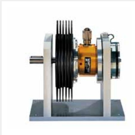
Prüfstand Größe II, Magnetpulverbremse mit integrierter Drehmoment-Messung, Drehzahlgeber zur Kennwertmessung von Motoren, Getrieben, Pumpen etc.
