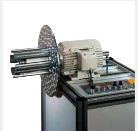
Randstreifenwickleinrichtung mit angebaute IEC
