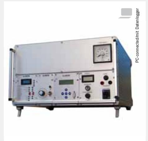
Tischgehäuse für Prüfstand, Liedtke digitaler Messverstärker LP24 für die Versorgung der Messbrücke, Istwertverstärkung und Datenlogger. LIEDTKE Controller M2302 Z2 mit PID-Regler und Display.
