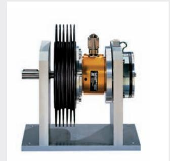
Prüfstand Größe II, Magnetpulverbremse mit integrierter Drehmomentmessung
