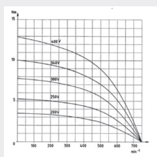
Drehmomentkennlinien bei unterschiedlichen Betriebsspannungen
